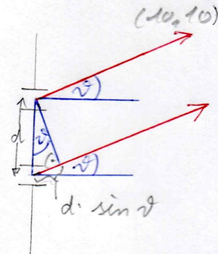
Nach (10.11) ist dies genau dann der Fall, wenn der Wegunterschied  $d$  sind von den beiden Spalten zum Beobachtungspunkt auf dem Schirm gerade ein ganzzahliges Vielfaches der halben Wellenlänge  $\lambda$  ist.
