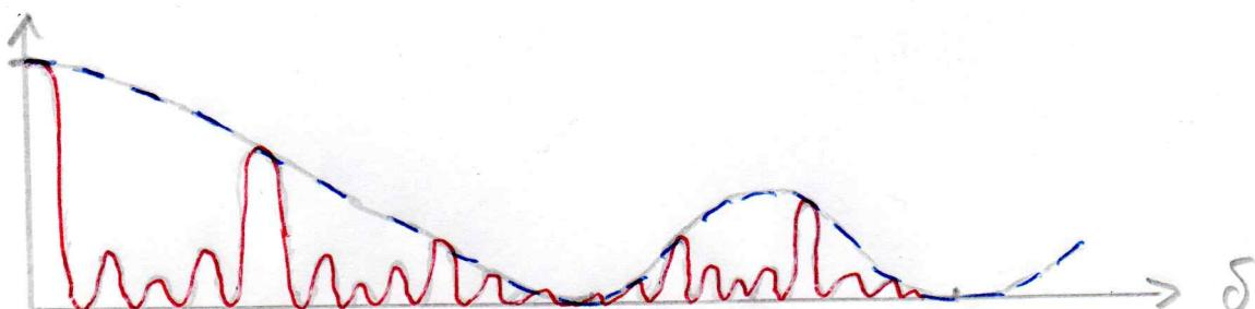
Entsprechend erhalten wir bei einem Doppelspalt mit endlicher Spaltweite  $\Delta$ :
