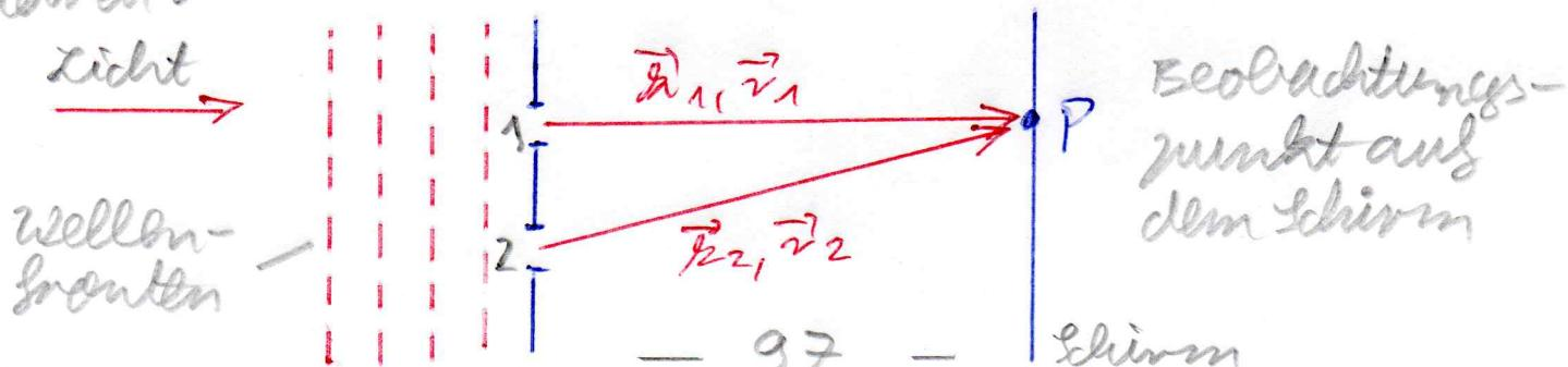
Jeder der beiden Spalte 1 und 2 ist Ausgangspunkt einer Elementarwelle. Eigentlich handelt es sich bei diesen Elementarwellen um zuwellen. In einem großen Abstand von den Spalten kann man aber diese näherungsweise als ebene Wellen behandeln:
