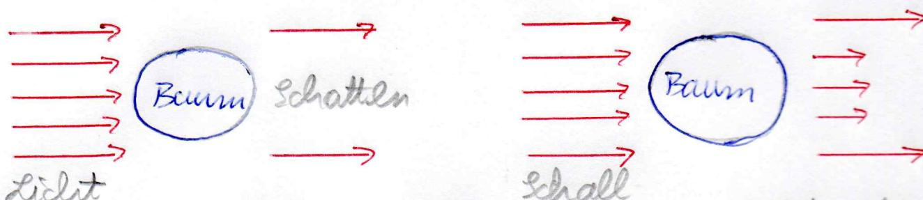
Im ersten Fall ist die Wellenlänge des Lichts sehr viel kleiner als die geometrische Sichtweite des Baums. Deshalb kann das Licht nicht direkt hinter dem Baum gelangen, es bildet sich dort ein Schatten aus. Im zweiten Fall dagegen ist die Wellenlänge des Schalls von der Größeordnung der Baumabmessungen, so dass der Schall zum Teil auch direkt hinter dem Baum durch Beugung auftreten kann.
