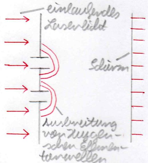
Interferenz ist eine Überlagerung von Wellen, so dass die resultierende Gesamtintensität ungleich der Summe der Einzeltensitäten ist. Beide Interferenzen von Lichtwellen entstehen auf dem Schirm hell und dunkle Interferenzstreifen. Das Auftreten von Interferenzlinien findet man nur bei Wellenphänomenen.
